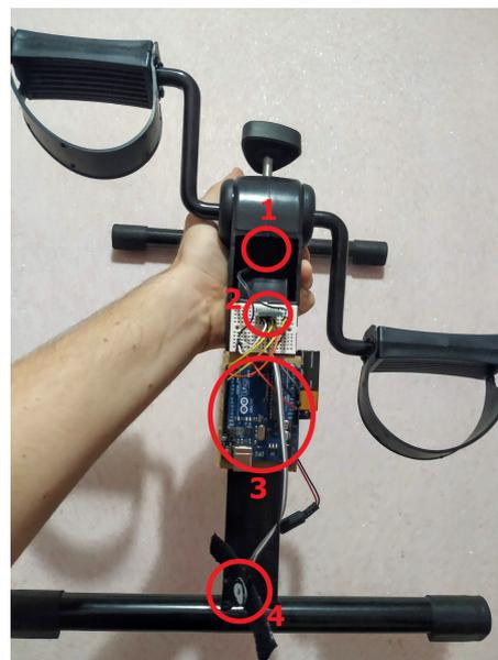
Figura 2. Adaptação feita no cicloergômetro. (1) Reed Switch, (2) Módulo Bluetooth, (3) Arduino e (4) Sensor de Batimentos Cardíacos.
