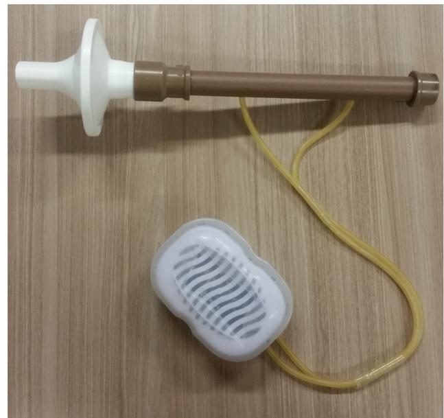
Figura 9. Equipamento Pneumotacógrafo (PITACO)
