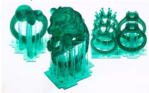
Figura 2. Impressões 3D com colunas para sustentar a produção [4].
