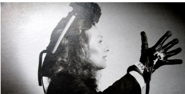
Figura 3: A Data Glove, produzida pela pioneira em RV, VPL (1985).
