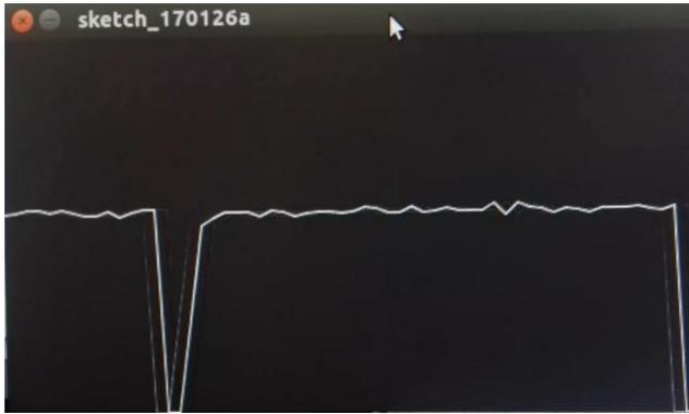
Figura 6: Captura da tela do programa Processing, mostrando o recebimento do sinal elétrico da bicicleta, após passar pela placa Arduino Uno.
