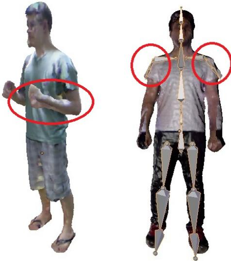
Figura 12: A imagem à esquerda apresenta uma falha na reconstrução no braço esquerdo; a da direita, exibe um esqueleto posicionado de forma incorreta.
