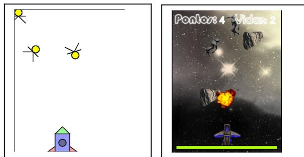
Figura 1: Protótipo de jogo desenvolvido pelo mesmo grupo de alunos em dois momentos diferentes: desenho no elemento canvas através do uso de primitivas da API Javascript (à esquerda) em comparação com o uso de imagens (à direita).
