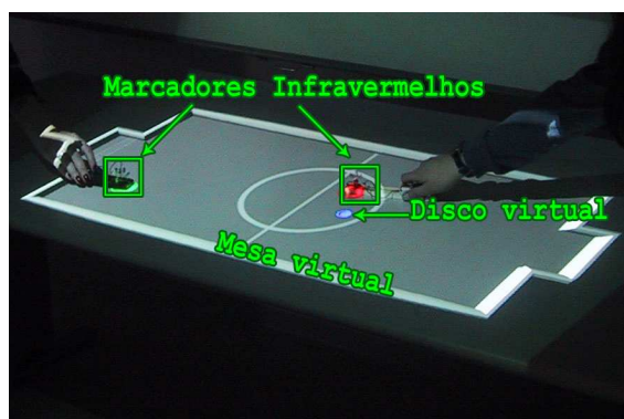
Figura 11: Seção de testes do protótipo atual do ARHockey
