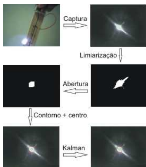
Figura 6: Fluxograma de uma iteração do sistema de rastreamento
