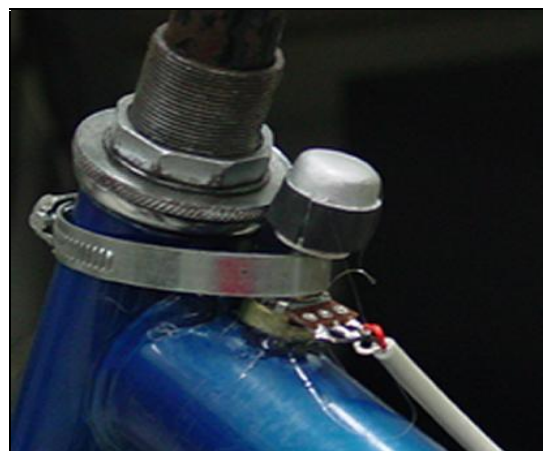
Figura 9: Esquema do potenciômetro para aquisição da rotação do guidão.
