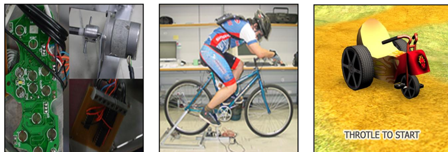
Figura 1: O dispositivo háptico HapticCycle: a) alguns componentes eletrônicos usados na construção do controle háptico; b) versão final do dispositivo; c) aplicação desenvolvida para validação do dispositivo.
