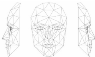
Figura 3: Representação gráfica da máscara CANDIDE-3 [1], que é uma simplificação dos principais pontos que caracterizam e movimentam uma face.
