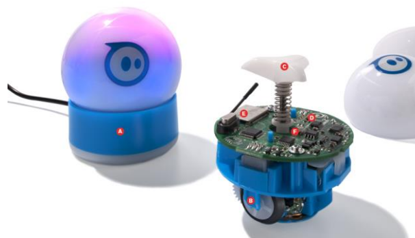
Figura 5: Sphero e seus principais componentes.
