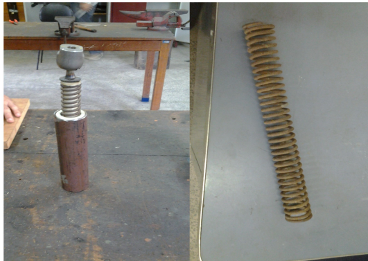
Figura 4: Amortecedor e mola utilizados no sistema.
