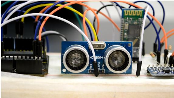
Figura 16: Sensores conectados ao Arduino UNO, em uma *protoboard*.
