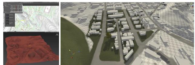
Figura 5: Reconstrução do relevo: a partir de plantas contendo curvas de nível do terreno (esquerda-topo) realizou-se o procedimento de construção do terreno (esquerda-base). Num segundo momento, foi colocado blocos para demarcarem onde as reconstruções seriam inseridas (direita).
