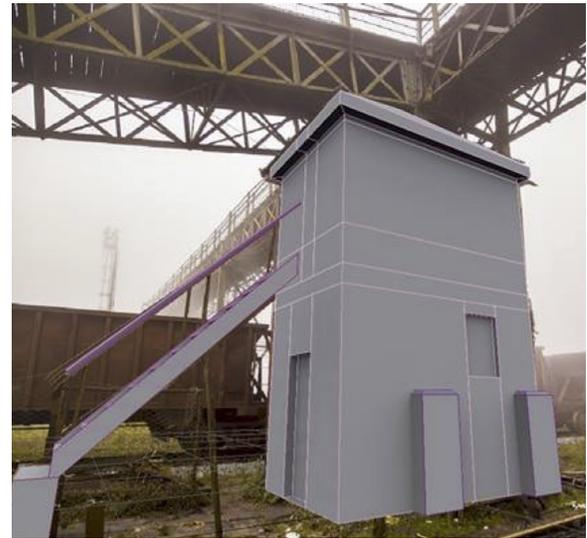
Figura 6: Reconstrução por Projeção: uso do *add-on* BLAM do Blender.
