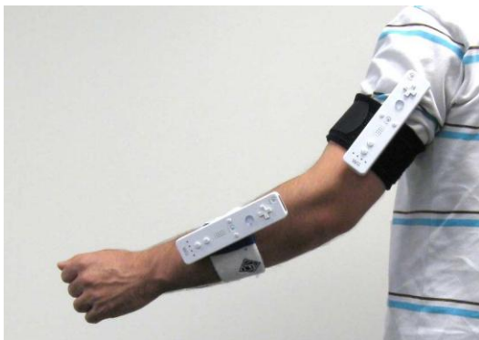
Figura 10: Interação com o jogo Helicopter utilizando dois Wiimotes posicionados no braço e no antebraço.
