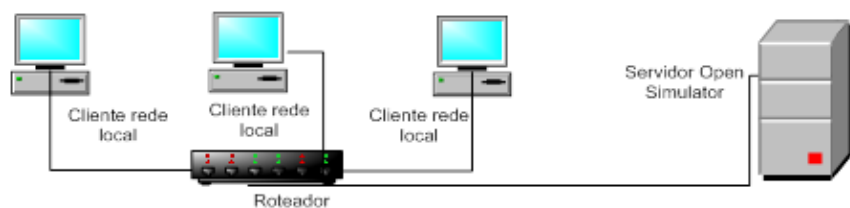
Figura 3: Arquitetura para acesso via rede local
